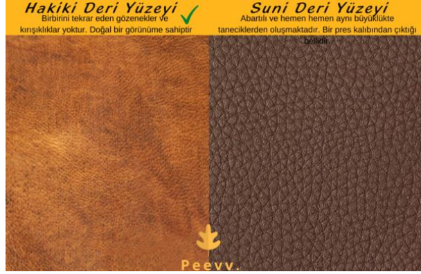
Şekil 36. Orijinal ve Suni Deri Karşılaştırması (URL 43)
